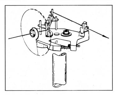
Abb. 6: Fadendurchlauf durch den Kompensations-Fadenspannungsregler KFD
