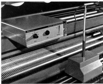
Tensoscan an einer Zettelmaschine
