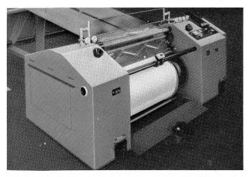
Abb. 2: Variabel einsetzbare Direkt-Schärmaschine DSV 50/30
