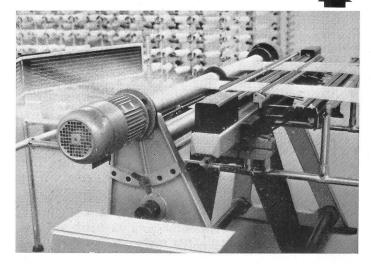
Positiv angetriebenes Walzenaggregat WA
