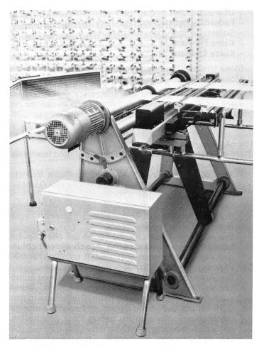
Abb. 9: Walzenaggregat WA mit geregeltem Eigenantrieb durch Gleichstrommotor (oder mit Induktionsbremse gebremst) für konstante, ständig kontrollierte Fadenspannung (Fadenspannungsausgleich), die im grossen Bereich zentral wählbar ist
