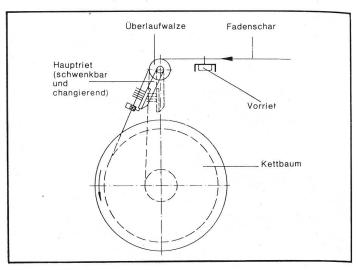
Abb. 5: Überlaufwalze mit changierndem, schwenkbarem Hauptriet
