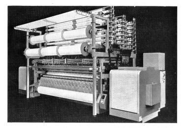
Die Karl Mayer Textilmaschinenfabrik GmbH hat ein völlig neuartiges Musterungssystem für mehrbarrige Raschelmaschinen entwickelt, mit dem sich die Musterwechselzeit von teilweise mehreren Stunden drastisch auf wenige Minuten reduziert. Damit schrumpft die Rüstzeit auf einen Wert, der in der Kalkulation fast vernachlässigt werden kann.
