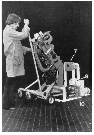
Abb. 6: Auswechseln der kompletten Spuleinheit am «Mayer-Coner RC 6»
