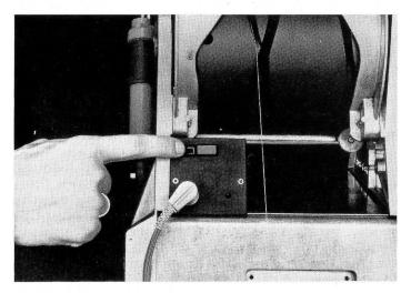
Abb. 4: Grossdimensionierte Fadenführungstrommel
