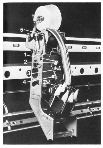
Abb. 5: Komplette Spuleinheit des «Mayer-Coners RC 6»
