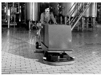
Bild 3 Reinigungsautomat Wetrok-Triomatic 813
