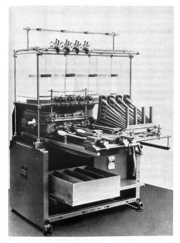
Der zunehmenden Fertigung technischer Gewebe für schwere Einsatzzwecke und der damit verbundenen Forderung nach grösseren Schussspulen hat HACOBA mit der Modellreihe SSA 6000 Rechnung getragen.
