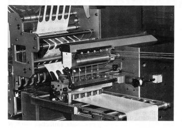
Die neue Maschine erledigt alle Arbeitvorgänge kontinuierlich – vom Abzug des bevorrateten Materials, Messen, Verlegen, Aufdrucken der Farb-Nummer, Verpakken, Verschweissen, Lochen bis hin zum Trennen und Vereinzeln der fertigen Folienpackungen.
