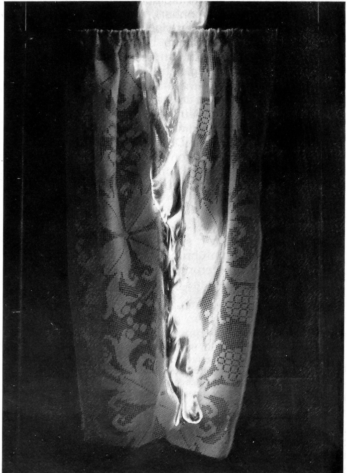
Abb. 7: Gardinenstoff Nr. 13, grosse Probe im Vollbrand
