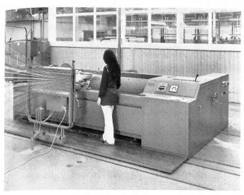
Abb. 1 Schärmaschine SC-PERFECT Schärseite
