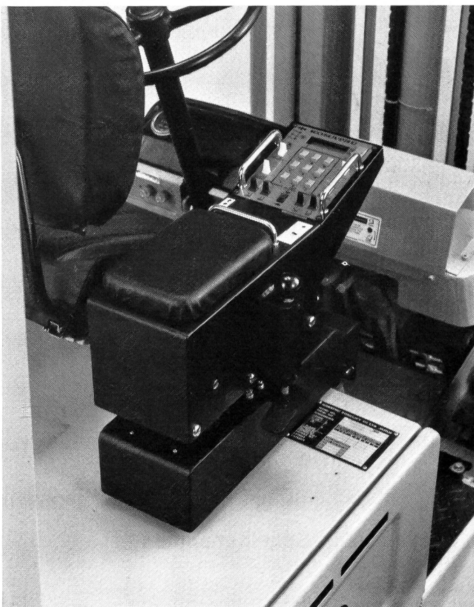
Bedienungsfreundliche Anordnung des Schaltcomputers mit gepolsterter Armstütze (Foto: Hulftegger, Stäfa)
