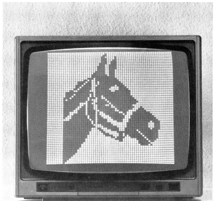
Abb. 5: Bildschirm mit angewähltem Teilbild von 64 Nadeln x 64 Musterreihen ( \hat{=} 4096 Knotenpunkte)
