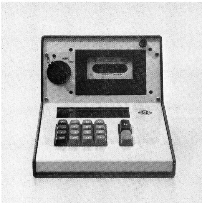
Abb. 2: Bedienpult mit Minimal-Tastatur und Bandgerät
