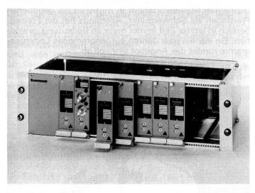
Das System 345 umfasst steckbare Temperaturmessumformer und Zusatzgeräte für die Verwendung in der Schaltwarte. Das Grundchassis im 19"-Eurokartenformat, nach DIN 41 494, nimmt bis zu 10 Einschübe auf und ist für Wand- oder Schalttafelmontage geeignet.
