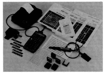
Abb. 1 Der HP-41 C und CV sind das Kernstück des neuen vollprogrammierbaren Rechnersystems von Hewlett-Packard. Das Gerät ist mit 130 technisch-wissenschsftlichen Funktionen vorprogrammiert. Zum Lieferumfang gehören Rechner, Kartenleser, Drucker, optischer Lesestift, Erweiterungsmodule, Magnetkarten und ausführliche Bedienungshandbücher. Durch das handliche Format und die netzunabhängige Einsatzmöglichkeit ist die ganze Anlage sehr mobil und überall
