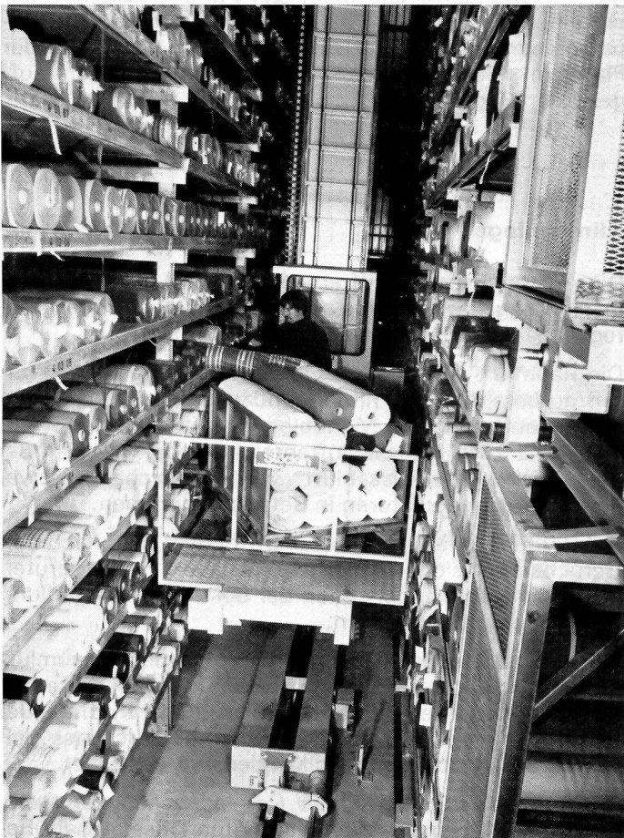
Stoffrollenlager: Einzelne Stoffrollen lassen sich leicht von der Palette ins Tablarregal überschieben.
