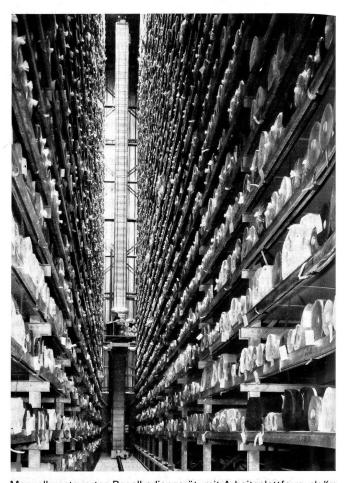
Manuell gesteuertes Regalbediengerät, mit Arbeitsplattform, als Kon missioniergerät, im Stoffrollenlager eingesetzt. Werkfoto Walter Stöcklin AG, Dornac
