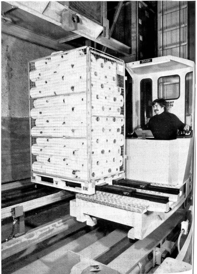
Palettenlager: Eine Garnpalette wird zur Auslagerung dem Kettenförderer übergeben.
