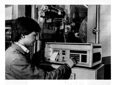
Die Karl-Mayer-Textilmaschinenfabrik GmbH, D-6053 Obertshausen, hat ein elektronisches Steuerungssystem für Kettenwirkautomaten und Raschelmaschinen entwickelt, mit dem die Fadenscharzuführung vollautomatisch geregelt wird und ausserdem Produktionsdaten erfasst werden können. Das neue System kann anstelle des mehr als 150 000fach bewährten mechanischen Systems eingesetzt werden.
