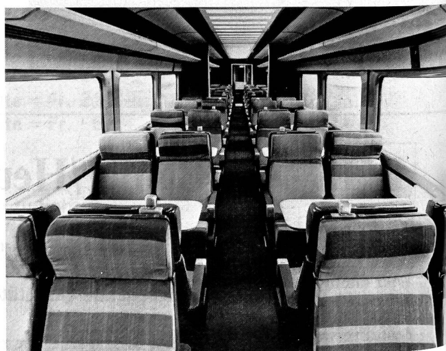
1. Flammfeste Wolle von Reuben Gaunt aus der nordenglischen Grafschaft Yorkshire wird von der britischen Eisenbahn in ihrem neuen Personenwagen «Mark III» verwendet, der für den Spitzengeschwindigkeiten von 200 km/h erreichenden High Speed Train bestimmt ist. (BFF)
