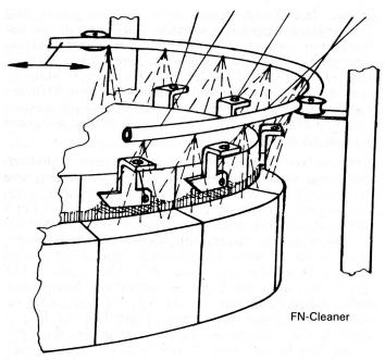
gesetzt werden kann, erfüllt der FN-Cleaner die Aufgabe, den Bereich der Fadenführer und der Nadeln von Schmutz- und Flusablagerungen freizuhalten.
