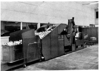
der fertig gespulten Kreuzspulen fördert nicht nur die Leistung der Spulerin, sondern sorgt gleichzeitig für einen gleichbleibend hohen Nutzeffekt.
