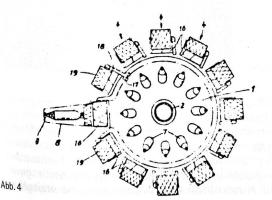
Der nächste Schritt zur weiteren Automatisierung lag nahe. Mit den steigenden Qualitätsansprüchen, verschärfter Garnreinigung und damit steigenden Fadenbrüchen wurde es notwendig, dass der moderne Automat Fadenbrüche selbsttätig behebt.
