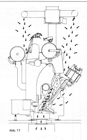
Messungen haben ergeben, dass der Feinstaubgehalt der Luft im Bedienungsbereich der Spulerin von mehr als 1 mg/m³ auf unter 0,2 mg/m³ reduziert werden kann.
