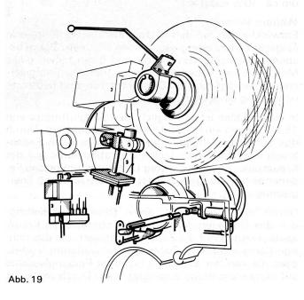
Eine spezielle Abhebebildstörung gibt den intensivsten Störeffekt. Selbst kritische Zellwollgarne, die hohe Reibung zwischen Fadenführungstrommel und Spule einerseits und geringe Reibung von Garn auf Garn andererseits bewirken, können jetzt problemlos verarbeitet werden.
