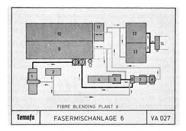
Die Partiekomponenten werden zunächst entsprechend ihrem prozentualen Anteil im Materiallager abgewogen und dann zur Partie zusammengestellt. Da im nachfolgenden Verarbeitungsprozess innerhalb der Mischanlage kein weiterer Wiegevorgang stattfindet, ist von Anfang an sichergestellt, dass alle Komponenten hundertprozentig in der Mischung enthalten sind.
