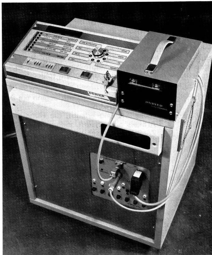
Bild 4 JET 2 (-F). Steuerschrank mit Datenänderungspult und schnell laufendem Aufnahme- und Lesegerät.
