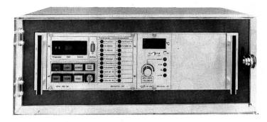
Durch die genormten Steckeinheiten, im 19-Zoll-Europaformat, lässt sich die Steuerung jedem Färbemaschinentyp anpassen.
