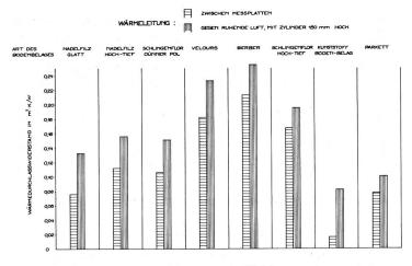
Abb. 2 Vergleich zwischen Messung mit Kühlplatte und gegen Luft
