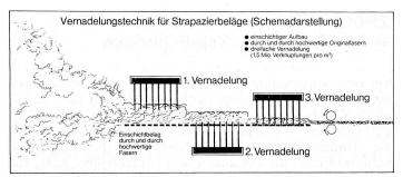
Dreifache Vernadelung für besonders hohe Strapazierfähigkeit: Bei der Herstellung von FFF fulda tennisstar, dem strapazierfesten Spezial-Tennisbelag der Filzfabrik Fulda, durchläuft das Faservlies dreimal die Nadelmaschine, wie es die Schemazeichnung vereinfacht darstellt. Die besonders dichte Vernadelung ist der Grund dafür, dass FFF fulda tennisstar auch extremen Belastungen im Sporthallenbereich unbeschadet standhält.
