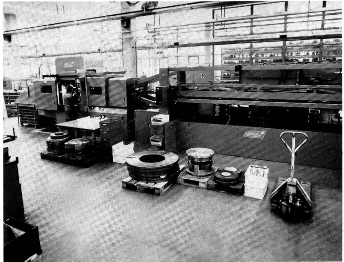
400-Tonnen-Feinstanzanlage bei GROB Horgen: Hier werden hochpräzise Stanzteile bis 10 mm Dicke hergestellt – einfach aussehende Produkte, die eben doch, neben jahrzehntelangen Erfahrungen, immer kompliziertere Verfahren und Maschinen erfordern.
