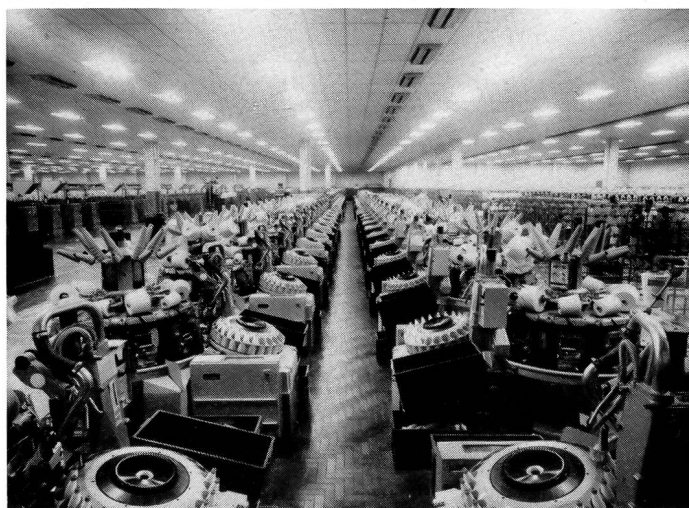
62 Schweizer-Coner CA 11 (620 Spindeln) in einer hochmodernen Rieter-Spinnerei in Nord-Brasilien.
