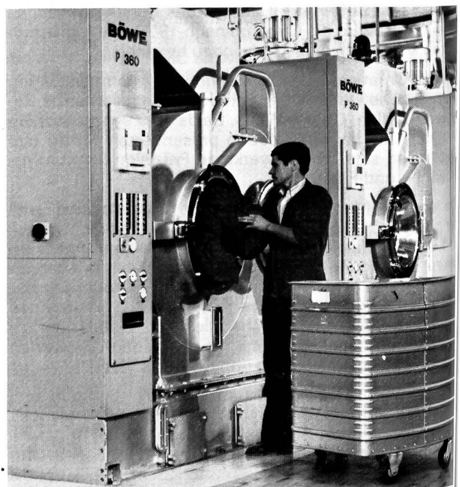
BÖWE P 360 ST Lösemittel-Trommelmaschinen Füllmenge 60 kg – für die Ausrüstung von Strickteilen im Einsatz
