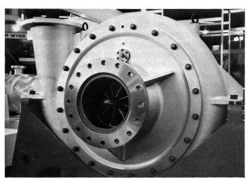
CCM-Sulzer-Entspannungsturbine für Freon-Kreislauf (rückgewonnene mechanische Leistung: 1,3 MW).
