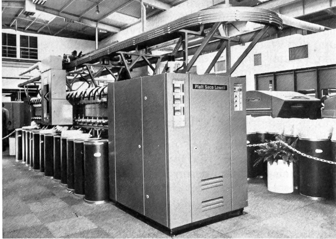
Die Zweiseiten-Spinnmaschine des Typs 887 von Platt Saco Lowell verfügt über einen äusserst schnell arbeitenden Fadenleger/Reiniger und einen Abnehmer für volle Garnkörper und arbeitet in einem Nenn-Betriebsgeschwindigkeitsbereich von 30 bis 70 000 min -1 .
