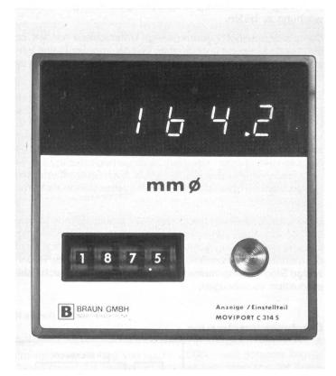
Anzeigeeinheit mit Grenzwerteinsteller für die Durchmesser-Erfassung
