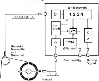
Funktionsschema der Durchmesser-Erfassung
