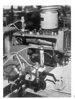
Abb. 1: Steuerung der Haltenadeln für ein Rapport-Zuschneidesystem über Druckluftzylinder (Desmed & Meynart / Brüssel/B)
