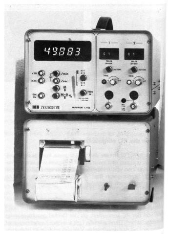
Digitales Messgerät für Drehzahl, Geschwindigkeit, Verhältnis, prozeituale Differenz zum beweglichen Einsatz, dazu Messwertdrucker
