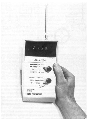
Digitaler Hand-Drehzahlmesser 100 U/min.. 1 Mill U/min
