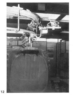
Abb. 7: Industrienähmaschine für das Zusammennähen von Bahnen für Beduinenzelte (Jentschmann AG / Zürich/CH)
