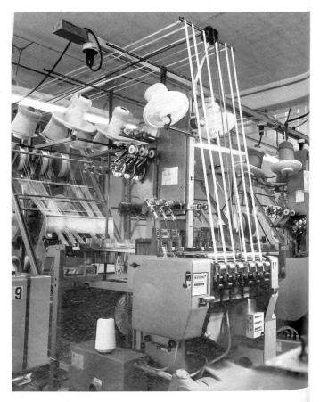
Teilansicht eines modernen Webautomaten für Schaftbänder mit einer Leistung von über 2000 Trs./Min.
