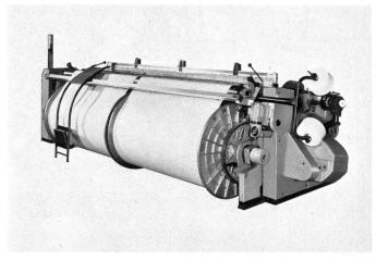
Frottierwebmaschine des Typs PU 130 ZSD KR G (Abb. 4)
