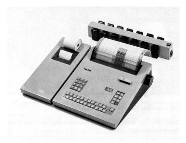
Programmiergerät mit Löscher und Drucker (Abb. 10)
