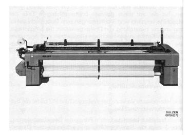
Hochleistungs-Projektilwebmaschine des Typs PS 3600 ES E6 (Abb. 6)
