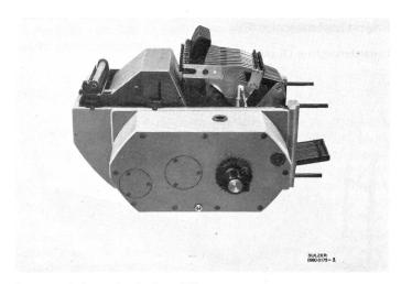
Programmierbare, durch einen Mikroprozessor angesteuerte Exzentermaschine SEM (Abb. 9)
