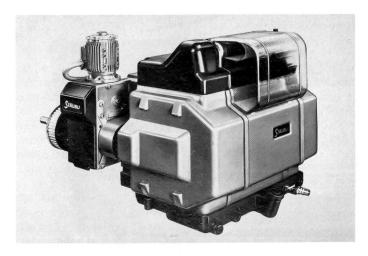
Stäubli-Gegenzug-Schaftmaschine Typ 2232 mit der Schussuchvorrichtung Typ DA40 mit Einzelmotor-Antrieb und Druckknopf-Steuerung.
