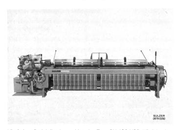
Vierfarben-Projektilwebmaschine des Typs PU 130 VSD KR D1 mit einer maximalen Arbeitsbreite von 3340 mm, ausgerüstet mit Kartenschaftmaschine (Abb. 1)
