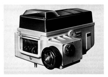
Rotations-Schaftmaschine Typ 2430 (System Stäubli) mit integriertem Kartenmagazin für max. 2500 Schüsse.
