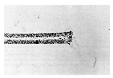
Quellung einer Polyamid 6.6-Faser in Ameisensäure/Essigsäure-Reagenz, Vergrösserung ca. 300x (Bild Nr. 4)
