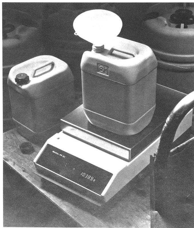
unstabilen Rollwagen noch ermöglicht. Gefäße tariert der Benutzer durch Tastendruck aus. Die neuartige Einwägehilfe Mettler-DeltaDisplay lässt die Anzeige beim Grobeinfüllen (unabhängig vom gewählten Messzyklus) sofort reagieren und löscht als optische Erleichterung die letzte Stelle
