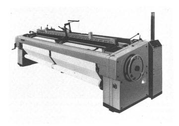
Neuentwickelte Luftwebmaschine LS von Sulzer.
