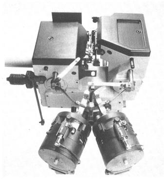
Zweifarbenaggregat der Hochleistungs-Projektilwebmaschine PS von Sulzer.
