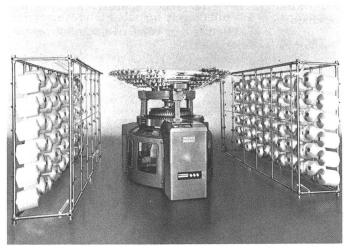
Hochleistungs-Interlockmaschine II 144 von Sulzer Morat für Qualitätsgestricke.
