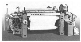
Saurer 100/2 – Einschützige Automatenwebmaschine mit elektronischer Steuerung – Blattbreite: 180 cm. Fachbildung: Exzentermaschine. Leistung: 240 T/min. Artikel: Popeline, 157,7 cm roh. Breite im Blatt: 159,6 cm – (ATME -I 80 Greenville/Exhibit Area 3-Booth No. 624)
