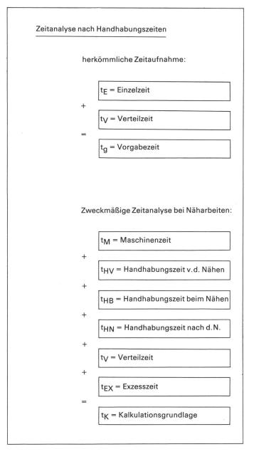
Gleichzeitig wird eine unzulässige Verallgemeinerung verhindert, die pauschal ein Pick-up oder eine Konturenführung, eine Verringerung oder Erhöhung der Drehzahl oder ein Stapelgerät empfiehlt. Im übrigen bietet dieses Schema eine Grundlage zur automatischen Analyse, Überwachung und Optimierung von Nähprozessen.
