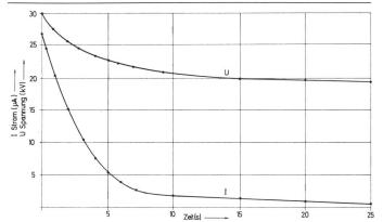
Fig. 6: Spannungs- und Stromkurve bei der Korana-Entladung durch die Metallfasern
