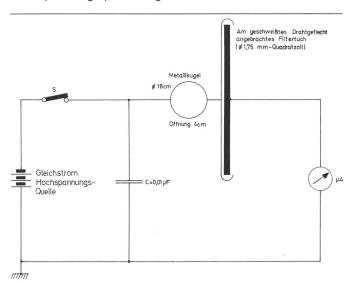
Fig. 5: Korona-Effekt Bekinox®-Fasern – Versuchsaufstellung
