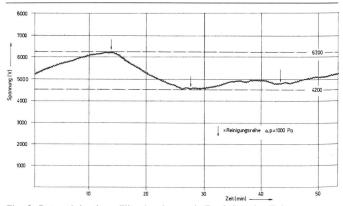
Fig. 3: Potentials eines Filterkuchens als Funktion der Zeit Filtertuch: Polyester + 1,79% Metallfasern. Pulver: Polyester
