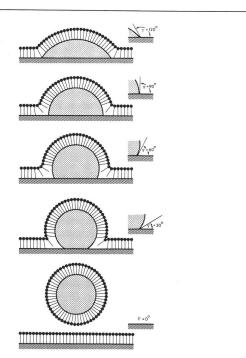
Abb. 13: Modellmässige Vorstellung der Ablösung eines Ölfilms von einer hydrophoben Oberfläche durch den Tensid
