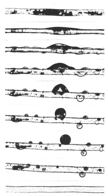
Abb. 12: Ablauf eines Waschvorgangs unter dem Mikroskop
