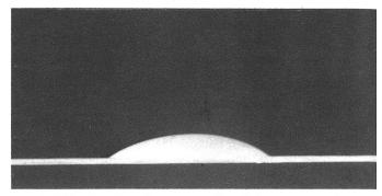
Abb. 6, 7 Ein Tensid verändert die Oberflächeneigenschaften des flüssigen Wassers erheblich. Reines Wasser benetzt eine Paraffinoberfläche nicht (Abb. 6); der Tropfen einer Tensidlösung dagegen bildet mit dem Paraffin eine Phasengrenzfläche aus (Abb. 7).
