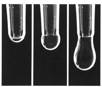
Abb. 2, 3, 4: Am sich bildenden Wassertropfen wirkt die Kohäsion als formerhaltende, die Gravitation als formende Kraft
