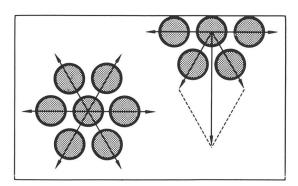
Abb. 5: Schematische Darstellung der in einem flüssigen Körper wirkenden zwischenmolekularen Kräfte
