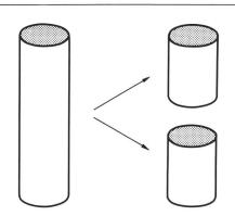
Abb. 1 Schematische Darstellung zur Definition der Kohäsionsarbeit
