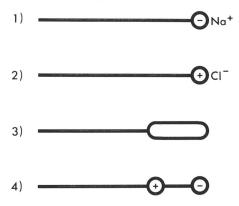
Abb. 8 Die Tenside werden in vier Gruppen eingeteilt. Gruppenmerkmal ist die Ladung des grenzflächenaktiven Ions: 1.) anionisches, 2.) kationisches, 3.) nichtionogenes und 4.) amphoteres Tensidmolekül.
