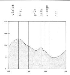
Abb. 5: Künstliches Nordhimmel-Tageslicht einer Macbeth-Spectralight-Tageslicht-Lampe
