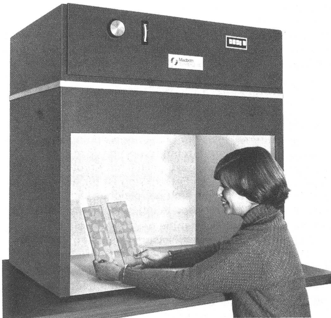
Abb. 8: Farbprüf-Kabinenlampe Macbeth-Spectralight mit Nordhimmel-Tageslicht 2×750 Watt (7500 K), kühlweisses Fluoreszenzlicht (4400 K), Sonnenuntergangslicht = Glühlampenlicht (2300 K) und Ultraviolett-Röhren. Die letzteren sind einzeln oder zu den andern Lichtarten zuschaltbar.
