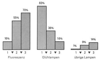
Bild 1: Lichterzeugung und Stromverbrauch mit den verschiedenen Lichtquellen für Allgemeinbeleuchtung
