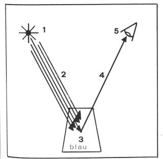
Abb. 1: Einfluss Lichtquelle/Farbmuster/Auge
