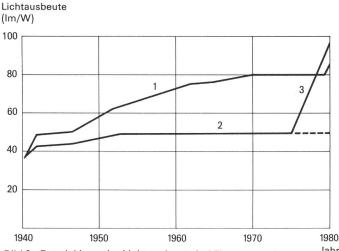
Bild 2: Entwicklung der Lichtausbeute bei Fluoreszenzlampen Ja
