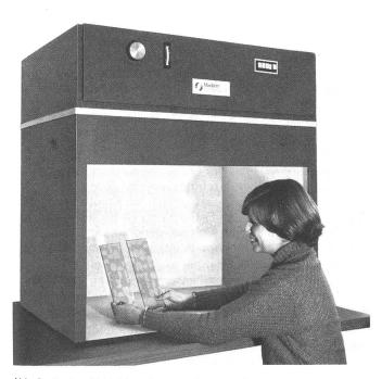
Abb. 8: Farbprüf-Kabinenlampe Macbeth-Spectralight mit Nordhimmel-Tageslicht 2×750 Watt (7500 K), kühlweisses Fluoreszenzlicht (4400 K), Sonnenuntergangslicht = Glühlampenlicht (2300 K) und Ultraviolett-Röhren. Die letzteren sind einzeln oder zu den andern Lichtarten zuschaltbar.
