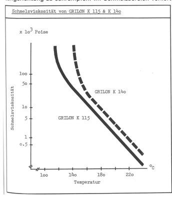
die Faser ihre Form gänzlich. Wie man aus dem Diagramm «Schmelzviskosität» ersehen kann, nimmt die Viskosität der Faserschmelze mit steigender Temperatur weiter ab. Es entstehen Schmelzknötchen, die sich vorzugsweise an den Kreuzungs- und Berührungspunkten der Fasern festsetzen und diese verkleben.
