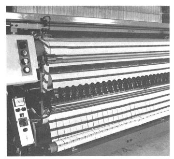
Moderne, schützenlose Webmaschine mit Etiketten-Trennvorrichtung
