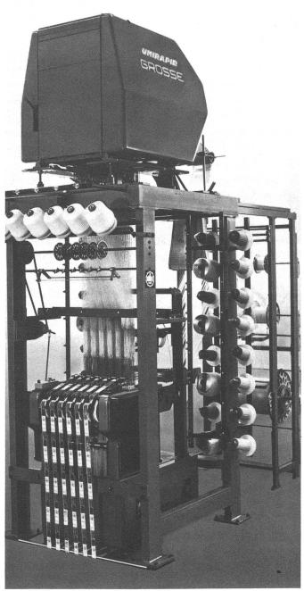
Moderne Nadelbandwebmaschine mit schnellaufender Jacquardmaschine
