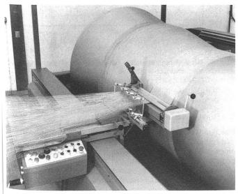
Abb. 4: Ansicht Schärtisch mit neuer Bandführung und Regelduo
