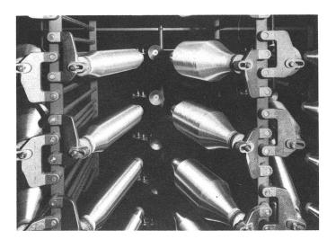
Immer häufiger kündigen die Chemie-Faser-Hersteller an, dass sie schon in nächster Zukunft einen Teil der Produktion von Streckzwirnkopsen auf Direktspinnstreckspulen umstellen. Einige Hersteller bieten diese Aufmachungsform bereits an.
