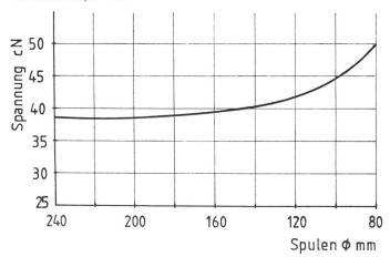
Abb. 5: Ohne Auftragsregelung: Verlauf der Fadenspannung, gemessen zwischen Rispe- und Schärblatt, infolge abnehmendem Spulendurchmesser
