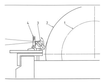
Abb. 3: Schema neue Bandführung mit Regelduo.
