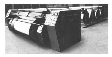
Die Assemblieranlagen WASp werden für Arbeitsgeschwindigkeiten bis 250 m/min geliefert, mit Web- und Zettelbaum-Durchmessern bis 1000 mm.
