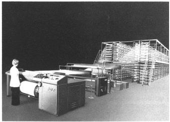
Die Anlage OZD-Z56 z.B. ist für die Zettlerin bzw. Schärerin optimal überschaubar gestaltet.
