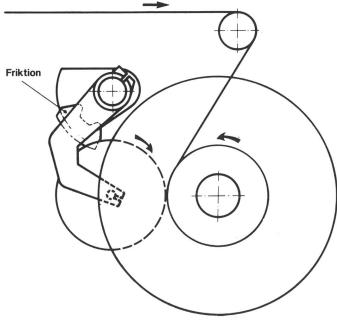
Andere Systeme arbeiten mit einer direkten Walzenanpressung. Hier ist die Gefahr gegeben, dass auftretende Wickelunebenheiten nicht ausgeglichen werden, sondern sogar verstärkt in Erscheinung treten.
