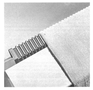
Cordsamt-Musterung. Es ist deutlich sichtbar, wie sich der Plüsch über den nicht abgesenkten Lamellen abhebt, wo er (vom nicht abgebildeten) Schermesser erfasst werden kann. In den Vertiefungen bleibt der Flor stehen. Durch die Vertiefungen der abgesenkten Lamellen wird ein seitliches Verlaufen der Ware verhindert und die Bildung der Rillen genau parallel zur Kante sichergestellt.
