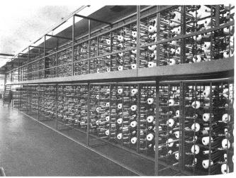
Mit dieser Hilfseinrichtung steckt eine Bedienungsperson die bis 20 kg schweren Kreuzspulen mühelos auf.
