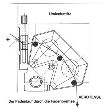
Die Belastung der beiden Tellerpaare erfolgt pneumatisch für alle Bremsen durch ein statisches Luftsystem.
