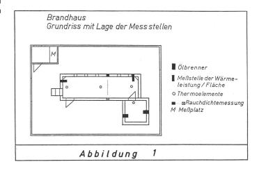
und 3 m Höhe, dem Brandraum, schliesst sich über eine Tür ein 2,5 m breiter und 9 m langer Korridor an. Am Ende des Korridors befindet sich ein Fenster, welches zur Ventilation des Prüfkorridors dient.
