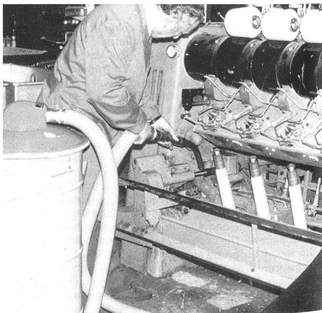
Regelmässige, gründliche Reinigung der Maschinen verhindert Überhitzung und damit Brandursachen. Die Hochleistungssauger gen. Absaugapparate saugen auch klebenden Flug, Schmiere usw. dank dem hohen Vakuum von 8000 mm WS und ermöglichen die Eliminierung von Druckluft zur Reinigung. (Abb. Absaugapparat AP-75 Abb. WILD AG ZUG)
