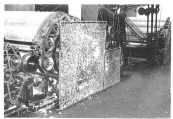
Bild 1 Dreisatzkrempel mit ungenügendem Schutzgitter
