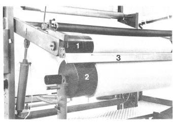
Bild 7 Wickler mit fest angebrachter Abdeckung
