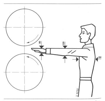
Bild 9 Erforderliche Walzenabstände bei Annäherung entsprechender Körperteile
