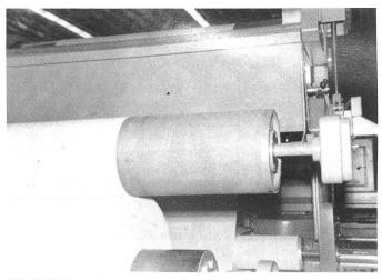
Bild 6 Wickler mit ausgeschwenkter Schutzhaube
