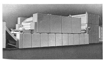
Abb. 3 Krempelteil einer Einkrempelanlage der Baureihe CU610-Trommeldurchmesser der Krempel 1500 mm.
