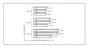
Abbildung 3 Grenzfertigungskosten für PES-Stapelfaserherstellung, Einsatzstoff: Granulat; Leistung 15-60 t/Tag, drei verschiedene Verfahrensvarianten
