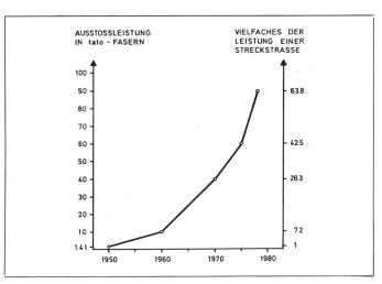
Abbildung 1 Steigerung der Leistung von PA- und PES-Streckstrassen von 1950–1978
