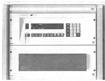
Abbildung 2 Faserlängen--Messgerät AL-100
