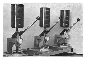
Stuhlbeintest (statische Prüfung auf das Eindruckverhalten).
