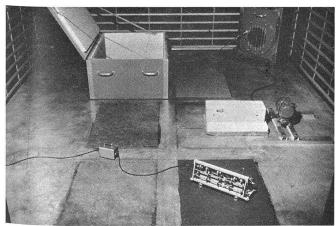
Messung der Trittschallisolation. Im Vordergrund befindet sich das Schlaghammerwerk. Im darunterliegenden Raum werden die Messungen durchgeführt.
