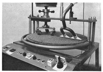
Rollstuhltest. Nach 5000 und 25 000 Umdrehungen des Probentisches wird der Teppich beurteilt. Die Rollen liegen mit je 300 N auf dem Teppich.
