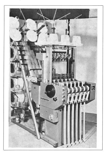
Die drei Supertex-Webstühle werden mit 8/30, 6/45 und 4/65 bezeichnet, wobei die erste Zahl die Menge gleichzeitig hergestellter identischer Gewebebahnen angibt, die zweite Zahl hingegen die maximale Breite jeder Bahn in
