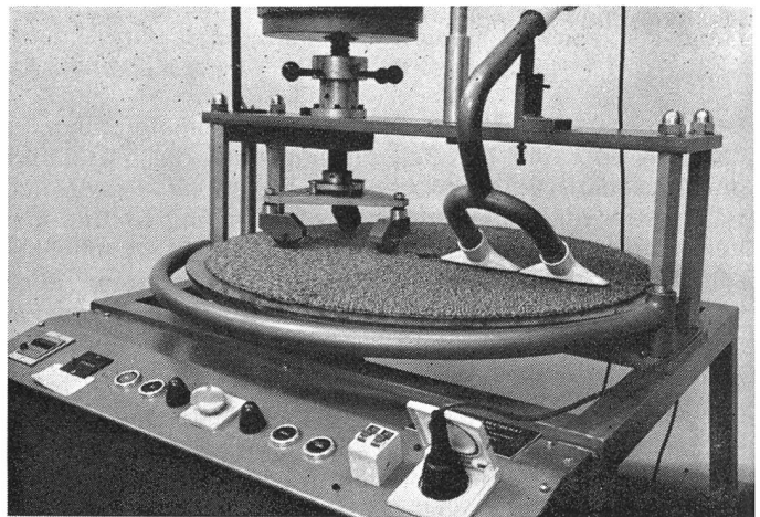
Rollstuhltest. Nach 5000 und 25 000 Umdrehungen des Probentisches wird der Teppich beurteilt. Die Rollen liegen mit je 300 N auf dem Teppich.
