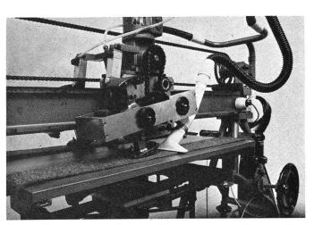
Tretrad System Lisson. Die vier Füsse werden mit Gummisohlen belegt. Sie bewegen sich mit 20 % Schlupf über die gespannte Teppichprobe, die an der Vorderkante eine Art Treppenabsatz bildet.
