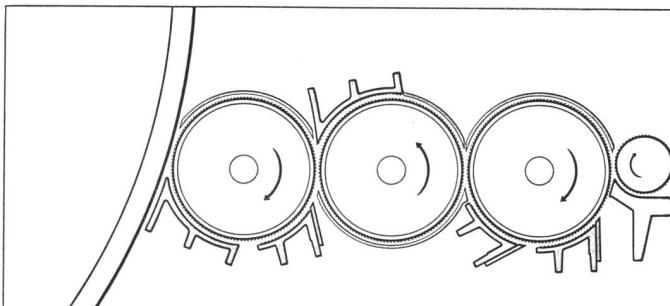
Da hohe Poduktionsleistungen heute meist durch schnel-lere Durchlaufzeiten (und weniger durch höhere Beauf-schlagungen) erzielt werden, braucht man eine bessere Vorauflösung der Flocken im Einlauf. Dies wird erreicht durch den Einsatz von Kardierplatten (u. a. Rieter) und/ oder mehreren Vorreissern wie z. B. bei Ingolstadt (Ab-bildung 2).
