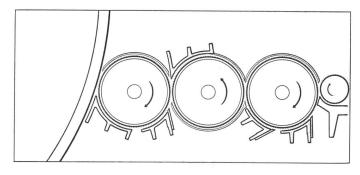
Da hohe Poduktionsleistungen heute meist durch schnellere Durchlaufzeiten (und weniger durch höhere Beaufschlagungen) erzielt werden, braucht man eine bessere Vorauflösung der Flocken im Einlauf. Dies wird erreicht durch den Einsatz von Kardierplatten (u. a. Rieter) und/oder mehreren Vorreissern wie z. B. bei Inngolstadt (Abbildung 2).
