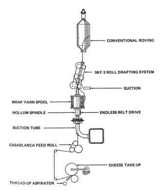
Ein konventionelles Flyervorgarn wird in einem normalen Ringspinnstreckwerk verzogen (Abbildung 8). Nach dem Streckwerk durchläuft der Faserverband eine sich drehende Hohlspindel mit aufgesetzter Filamentspule. Durch die Rotation dieser Spule wird fortlaufend Filamentgarn um die ungedrehten, parallelliegenden Kernfasern gewunden (Abbildung 9). Ähnliche Maschinen wurden auch von anderen Herstellern gezeigt.
