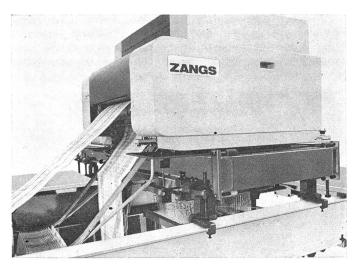
Zangs-Jacquardmaschine 356 Doppelhub-Ganzoffenfach mit Schrägfach, 1344 Platinen.
