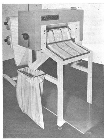
Kartenschnellstanze Patropunch® 528 innerhalb des Zangs-Patrocard-Systems® 525, einem rechnergesteuerten Verarbeitungssystems der Jacquard-Ateliertechnik, mit Abrolleinrichtung 527 für gerolltes Kartenpapier.
