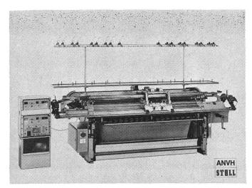
Abbildung 1: Gesamtansicht der Rechts/Rechts-Flachstrickmaschine Typ ANVH selectanit.
