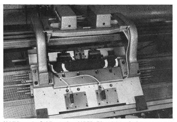
Abbildung 5: Schlitten der ANVH. Die elektronisch gesteuerten Auswahlsysteme wirken auf die Nadeln beider Nadelbetten und ermöglichen dadurch Gestricke in einer Wirtschaftlichkeit und Vielfalt von bisher nicht gegebenem Umfang.
