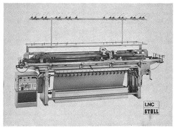
Abbildung 7: Gesamtansicht der Links/Links-Flachstrickmaschine Typ LNC selectanit.
