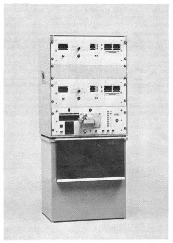
Abbildung 6: An den Schaltern des elektronischen Steuergerätes können Änderungswünsche an Gestricken mit wenigen Handgriffen verwirklicht werden.
