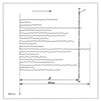
Abbildung 8 Durch den Kondensator ermitteltes Fasermuster
