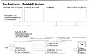
Abbildung 1 TEXLAB-System, Übersicht
