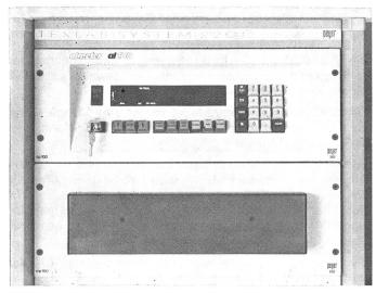
Abbildung 2 Faserlängen--Messgerät AL-100
