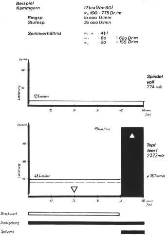
Abbildung 4 Vergleich Ringspinnverfahren/Stufenspinnverfahren. Laufzeiten: Streckwerk 4/5 der Zeit, Drahtgebung 5/5 der Zeit, Spulwerk 4/5 der Zeit.
