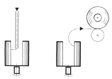
Abbildung 1 Stufenspinnverfahren nach de Feranti
