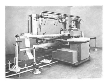
Abbildung: Die automatische Einziehanlage Uster Delta
