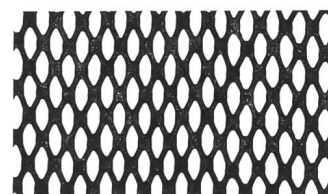
XIRO® – fertige Netzstruktur des XIRO®-Klebefilmes nach der Wärmezufuhr
