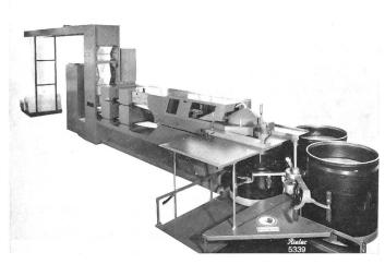
Converter mit einer Produktion bis zu 500 kg/h, bei einer Auslaufgeschwindigkeit bis 400 m/min. Die qualitativ verbesserte Bandqualität ergibt sich durch Fibrillenöffner, Ketten-Nadelstabfeld und neuartige Bandverdichtung. Die Bandablage in grosse Kannen (Höhe 1200 mm, 1000 mm  $\phi$ ) und der automatische Kannenwechsel bewirkt einen hohen Wirkungsgrad.
