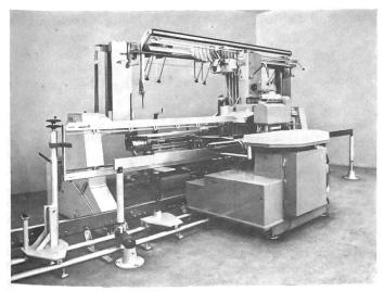
Abbildung: Die automatische Einziehanlage Uster Delta
