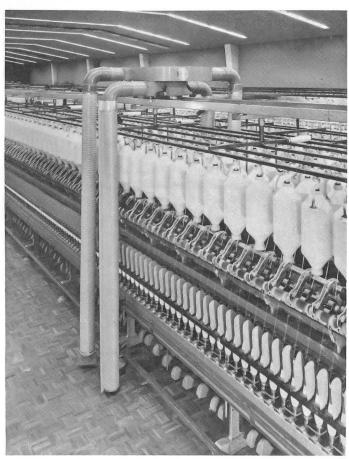
Durch schwenkbare Düsen und austauschbare Düseneinsätze kann die Beblasung jedoch allen individuellen Erfordernissen angepasst werden.
