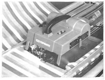
Abbildung: Die Webketten-Knüpfmaschine Uster Topmatic
