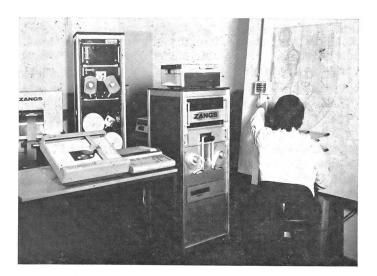
Kartenschnellstanze Patropunch® 528 innerhalb des Zangs-Patrocard-Systems® 525, einem rechnergesteuerten Verarbeitungssystems der Jacquard-Ateliertechnik, mit Abrolleinrichtung 527 für gerolltes Kartenpapier.
