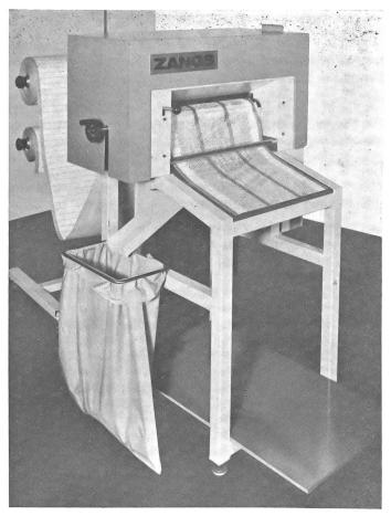
Zangs-Jacquardmaschine 356 Doppelhub-Ganzoffenfach mit Schrägfach, 1344 Platinen.
