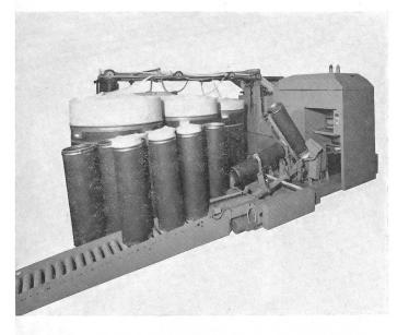
An der ITMA 1979 in Hannover hat die Firma Heberlein Hispano S.A. Genf zum ersten Mal eine Mischstrecke Hispablender mit sogenanntem O.E.-Kannenwechsel gezeigt. Diese neue Vorrichtung bietet grosse Vorteile für Spinnereien, die mit O.E.-Maschinen arbeiten.
