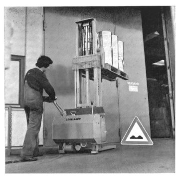
Wellenreiter EGV, ein neuer Deichselstapler mit Pendelantrieb zur Verbesserung der Bodenhaftung und zur Gewährleistung der ständigen Fahrbereitschaft beim Überfahren von Bodenwellen und -schwellen.
