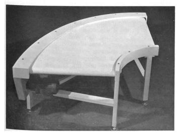
Der Einsatz von Kurvenbändern bewährt sich vor allem bei der Förderung kleiner Gegenstände, bei Gütern (bis ca. 50 kg), die nicht über Rollenbahnen umgelenkt werden können (Versperrgefahr) oder wenn in einem Materialfluss die Reihenordnung in Längs- und Querrichtung auch «in der Kurve» erhalten bleiben muss.
