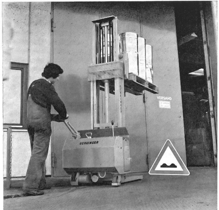
Wellenreiter EGV, ein neuer Deichselstapler mit Pendelantrieb zur Verbesserung der Bodenhaftung und zur Gewährleistung der ständigen Fahrbereitschaft beim Überfahren von Bodenwellen und -schwelen.
