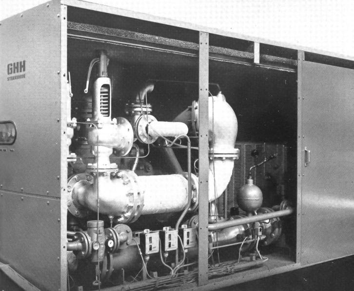
Über 20 Jahre Spezialerfahrung stehen hinter den kompakten Luftverdichteranla-gen der GHH STERKRADE. Neueste Ent wicklung sind die Aggregate mit zweistufigem Schraubenverdichter, Bauart SKT, mit besonders wirksamer Geräuschdämpfung. Es gibt fünf verschiedene Anlagen für Ansaugmengen zwischen 720 und 7.200 m³/h bei einem Enddruck von 10 bar. Alle Teile wie Luftfilter, Schalldämpfer, Rohrleitungen, Kühler, Überwachungsund Regeleinrichtungen sind auf kleinem Raum gut zugänglich und leicht aus-
